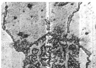
Рис. 9. «Цериевая пористость» в хромоалюминиевой стали 35X30Ю2ТЛ после обработки 0,5 % PЗМ ( $\times 600$ )
